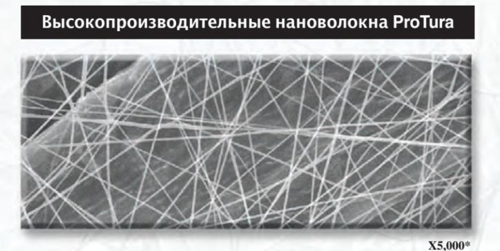
Высокопроизводительные фильтры компании Baldwin отличаются использованием самых тонких из производимых волокон, средний диаметр которых составляет около 90 нм (один нанометр составляет одну миллиардную часть метра). На фильтрующей поверхности задерживается больше загрязнений, что приводит к меньшему ограничению потока.
