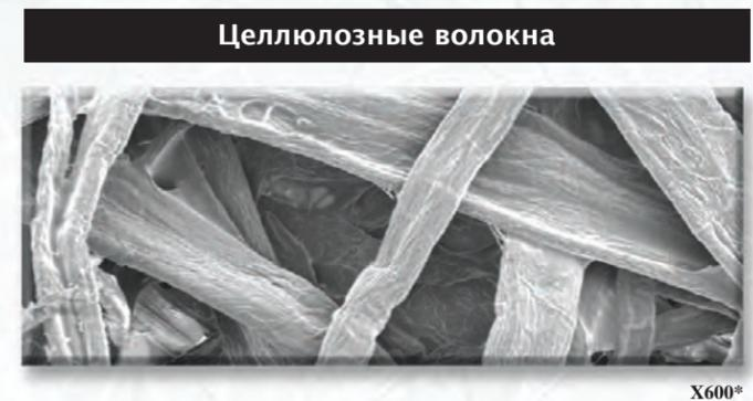
Размер обычных целлюлозных волокон намного крупнее, чем у нановолокон ProTura, а расстояние между обычными волокнами намного больше, чем между нановолокнами ProTura. Загрязнения погружаются глубоко в наполнитель, что приводит к увеличению ограничения потока и сокращению срока эксплуатации.
